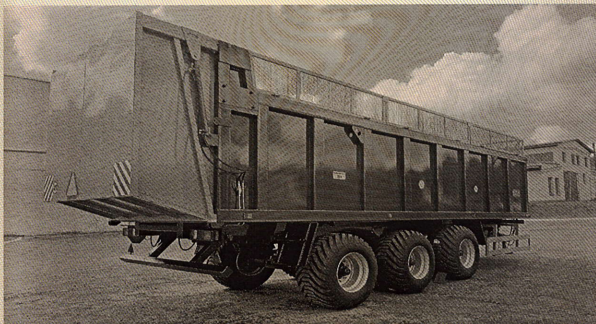
Рисунок 2. Фотографии ¾ переднего вида и ¾ заднего вида полуприцепа специального сельскохозяйственного типа ПСС-25 (вариант ПСС-25)
